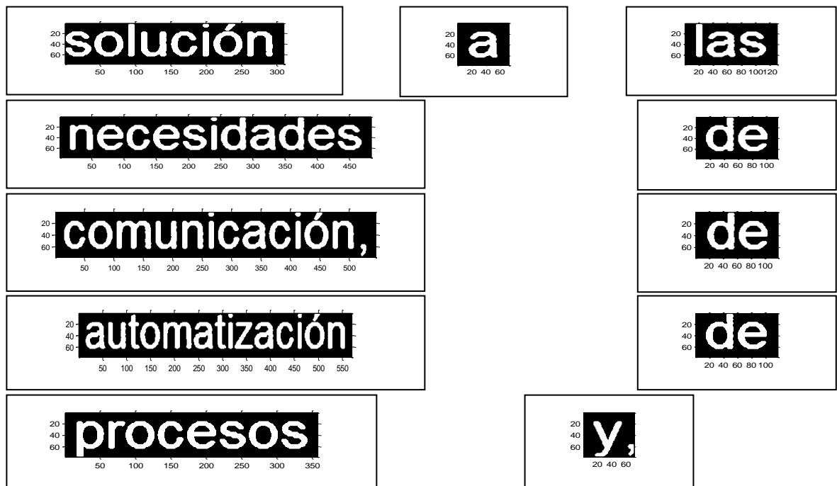
Figura 57 Imágenes de las palabras resultantes de la segunda etapa de segmentación para imagen de la Figura 55b.
