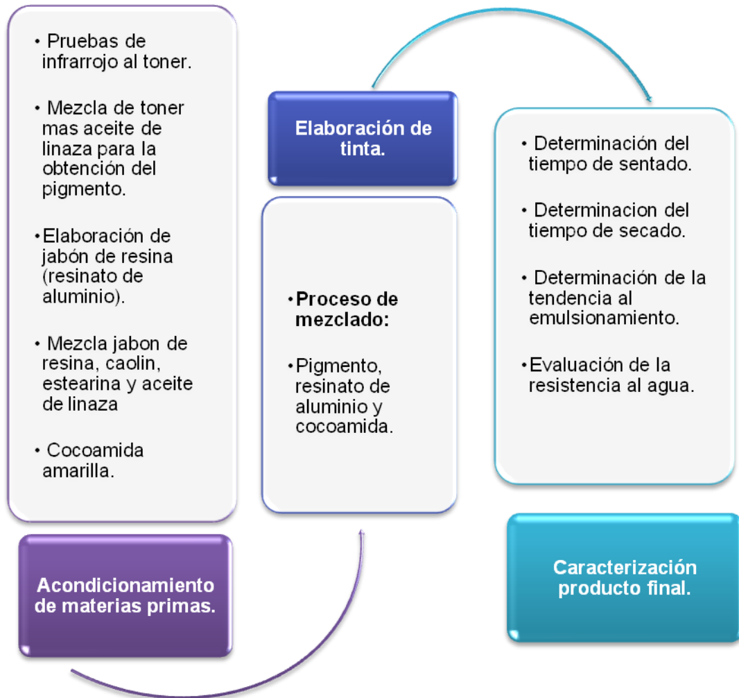
Figura 1. Esquema de elaboración de tintas
