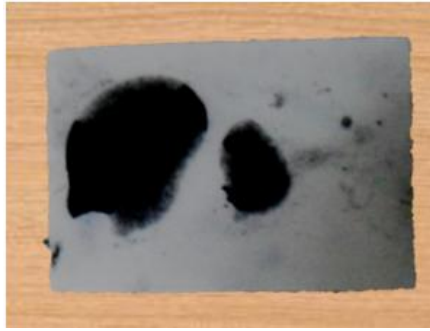
Imagen 18. Registro prueba resistencia al agua
