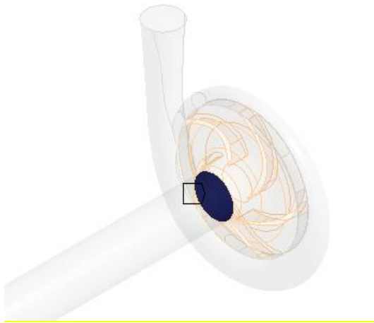
Figura 7. Interfaz tubo - dominio rotativo.
