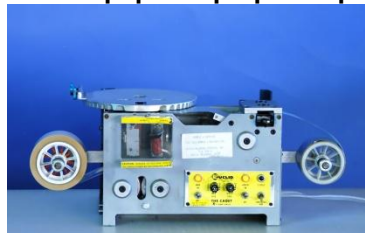
Figura 15. Equipo empaque de pastillas
