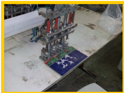
Figura 20: Ensamble Válvula desgasificadora
