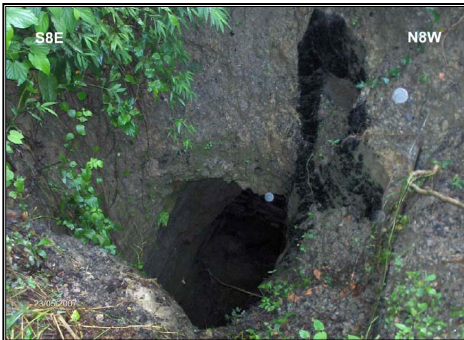
Figura 16. Galería en el costado izquierdo de la vía Bucaramanga – Barrancabermeja, donde se observa el manto de dos metros de espesor, coordenadas X: 1277503, Y: 1081258, a una altura de 529 msnm.
