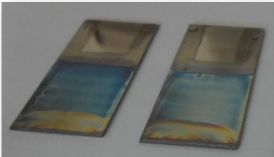
Película sin uso / Película después de fotoelectrocatalisis
