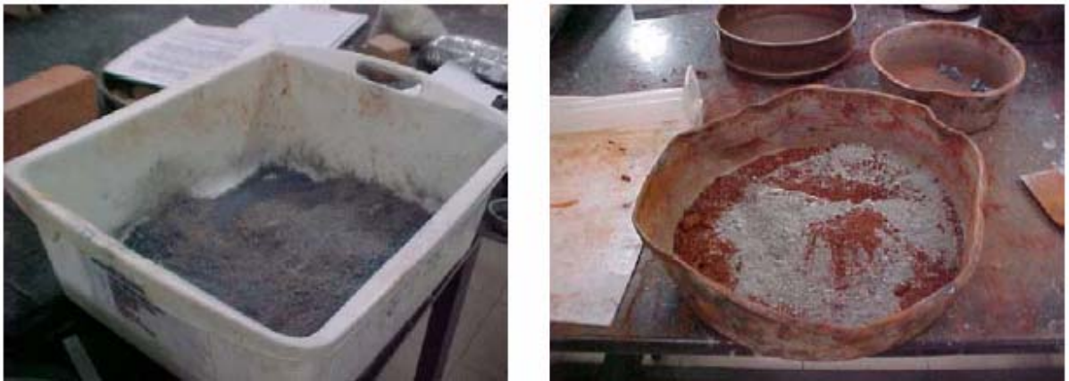
Figura 2. Mezcla de lodo con el cemento. Fuente: Pardo, 2005
