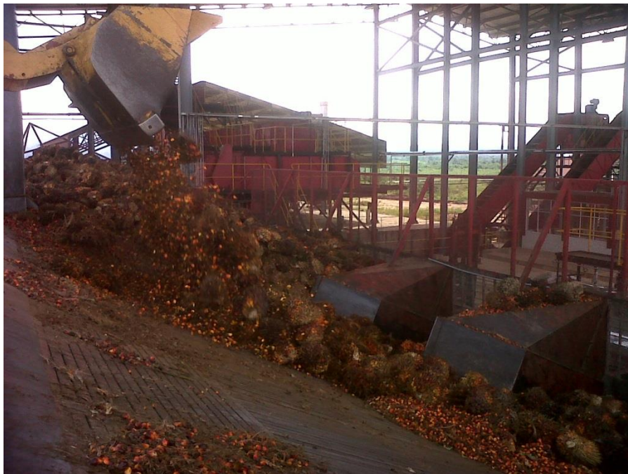
Figura 8. Tolvas de recepción
