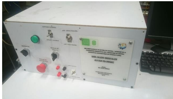
Figura 16. Centro de conexiones correspondiente al banco
