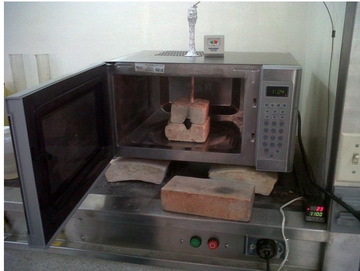
Figura 19. Sistema de medición de temperatura instalado en el horno microondas
