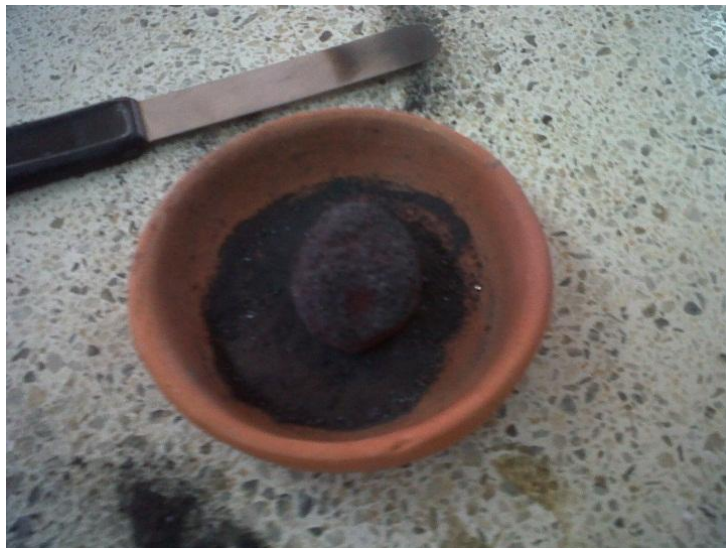
Figura 15. Sinterización de la muestra con el susceptor
