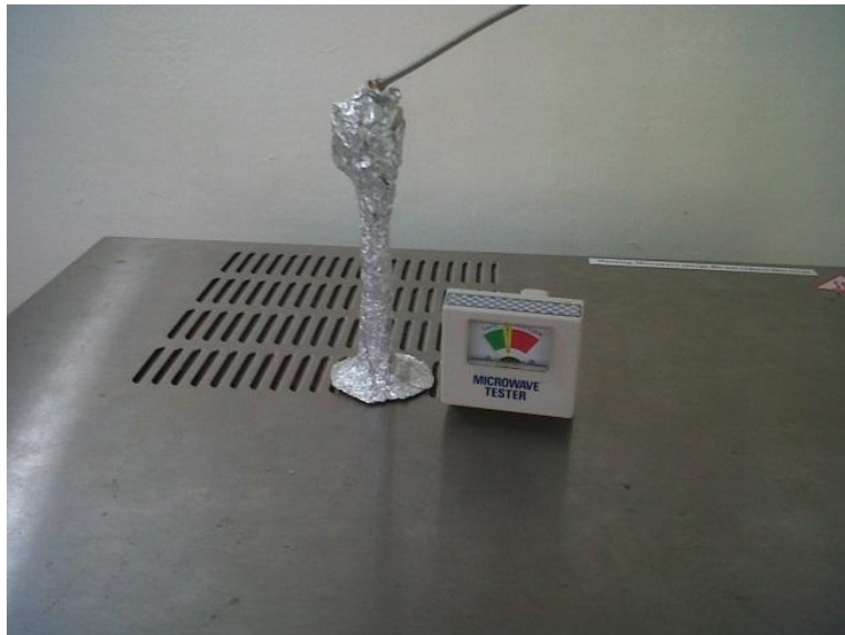
Figura 18. Sellado de fugas con papel aluminio
