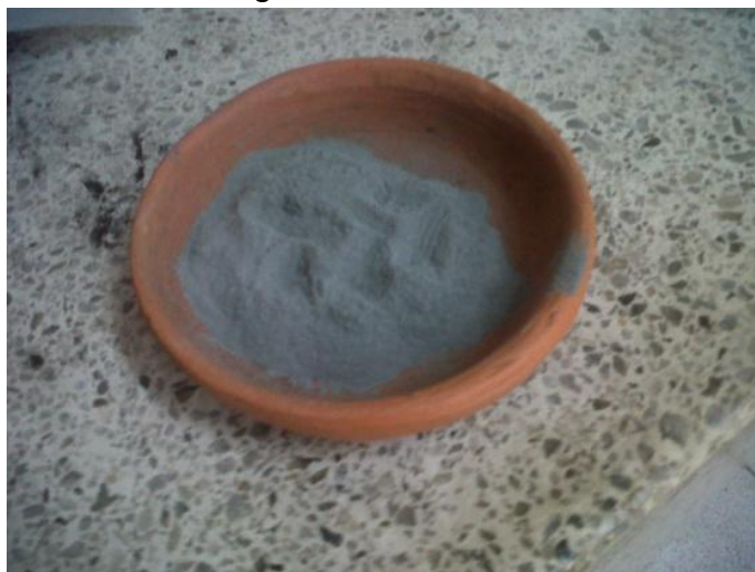
Figura 10. Carburo de silicio con granulometría < 50\ \text{nm}
