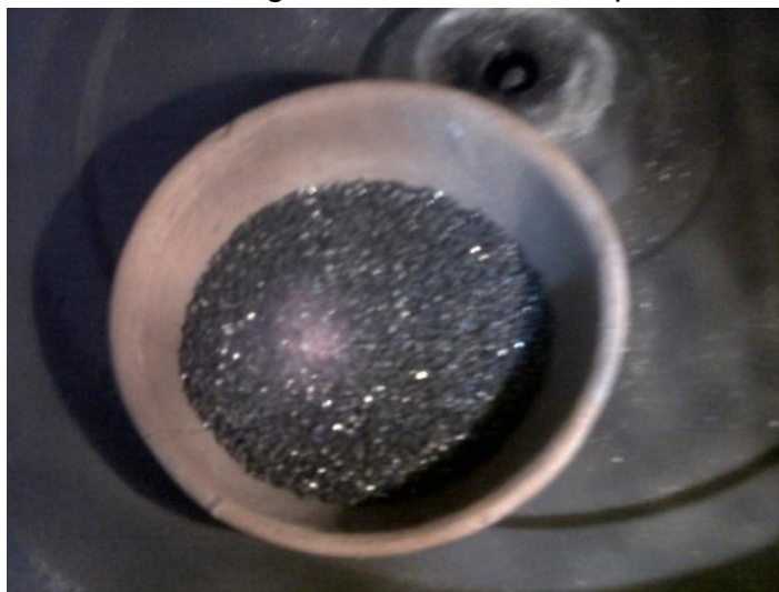
Figura 11. Carburo de silicio con granulometría de 297\ \mu\text{m}
