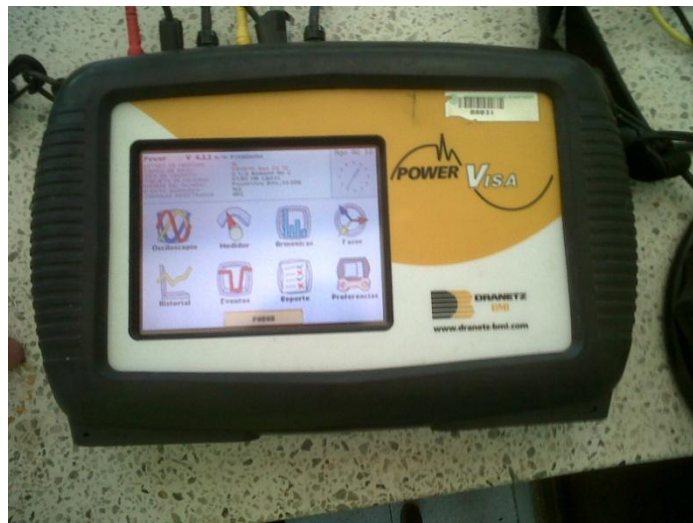
Figura 26 Analizador de calidad de potencia PowerVisa
