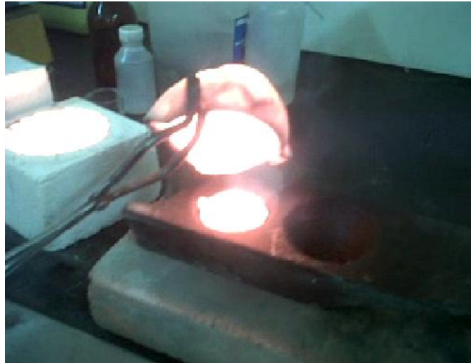
Figura 33. Fundición usando microondas
