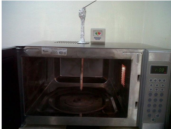
Figura 17. Adaptación del termopar al horno microondas
