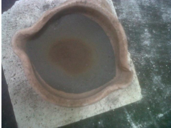
Figura 8. Calentamiento no homogéneo del mineral
