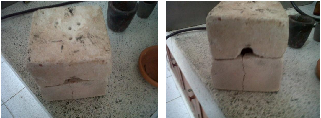
Figura 14. Ladrillo refractario modificado con aberturas en la parte superior
