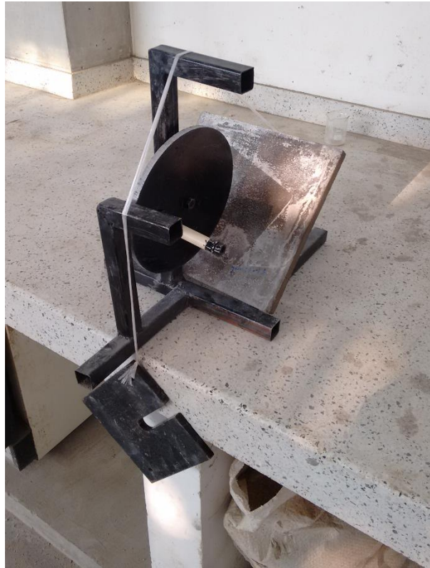
Imagen 6. Ensayo de Resistencia al Desgaste de una Baldosa
