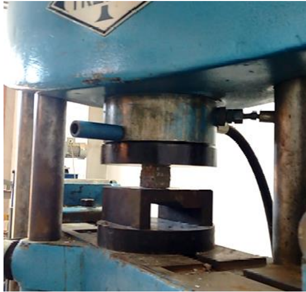
Imagen 8. Ensayo a compresión de un cubo en la máquina universal de ensayos
