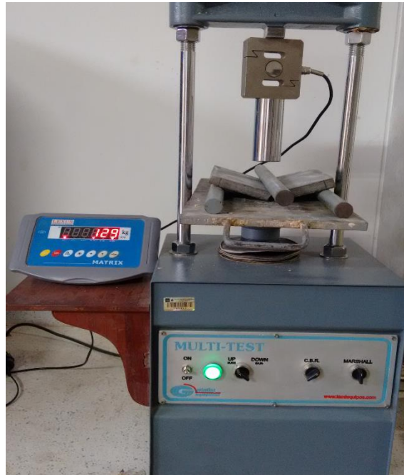
Imagen 5. Ensayo de Resistencia a la flexión en una Baldosa de 100% agregado natural
