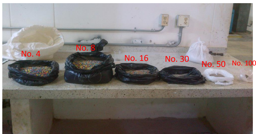
Imagen 1. Cantidades de material PEAD obtenidas para la mezcla del 5%
