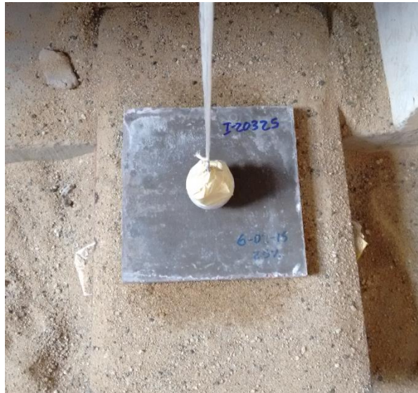
Imagen 4. Ensayo de Resistencia al choque de Baldosas con 25% de PEAD
