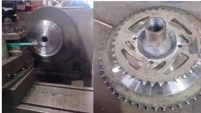
Figura 29. Mecanizado y soldadura del piñón.
