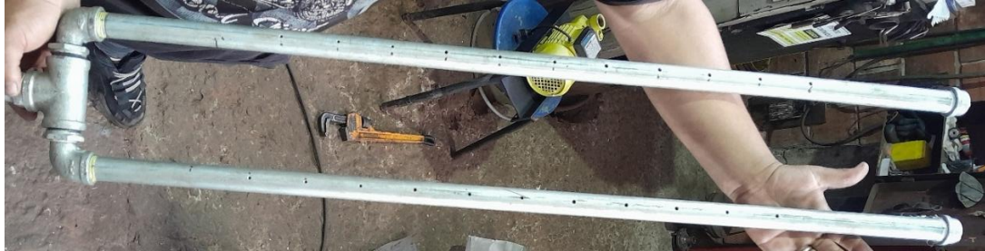
Figura 60. Tubería galvanizada perforada.
