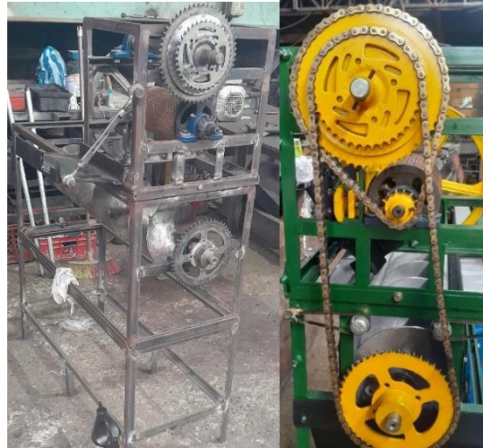
Figura 45. Transmisión de potencia por cadenas y piñones.
