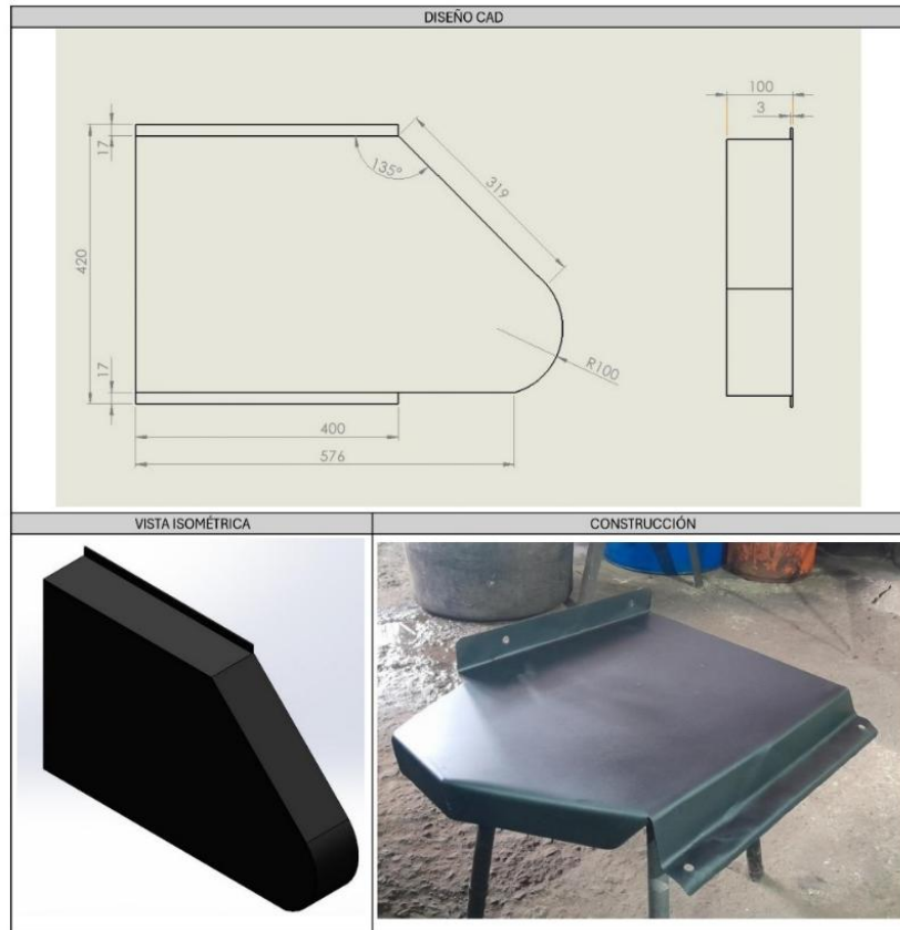
Figura 55. Guarda de transmisión de potencia de poleas y correas.
