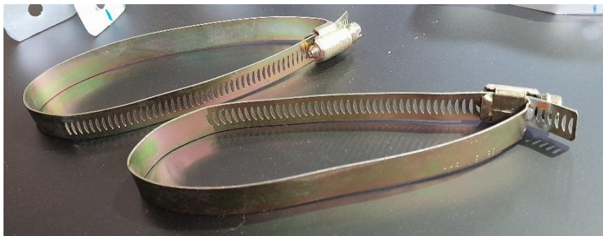
Figura 59. Abrazaderas metálicas para sujeción de tubos de agua a presión.
