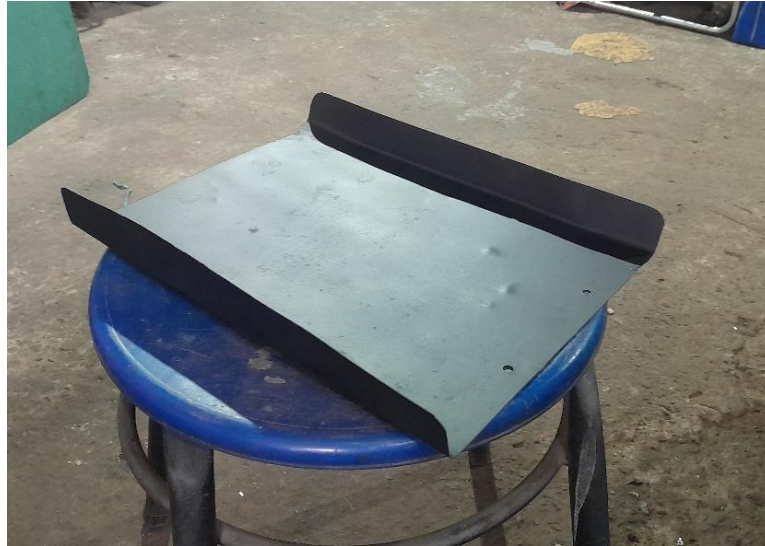
Figura 48. Guía par salida de residuos del café.
