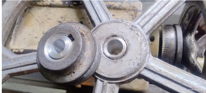
Figura 31. Bujes en poleas de aluminio
