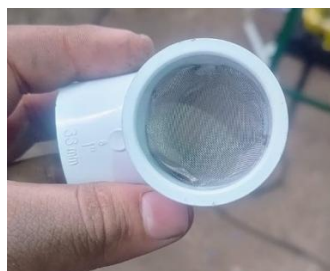
Figura 63. Filtros en la succión de la bomba.
