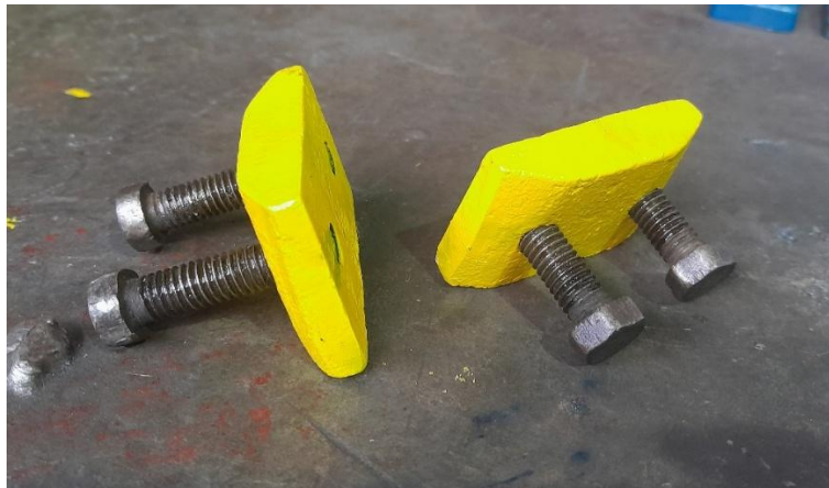
Figura 23. Cuñas de ajuste para graduación de pechera.
