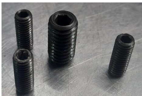
Figura 26. Tornillos prisionero para ajuste en poleas y piñones.
