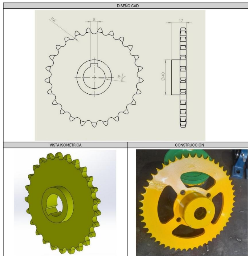
Figura 28. Piñón, transmisión de potencia al tornillo sinfín.
