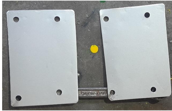
Figura 37. Laminas para sujetar guía del tornillo sin fin.
