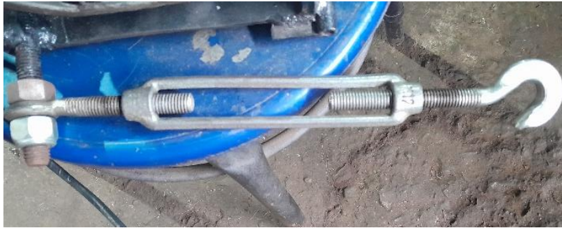
Figura 52. Tensor para ajuste en la correa.
