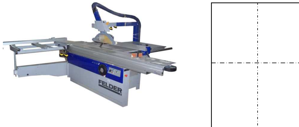
Figura N° 2. Sierra de disco 5.5. Kw. a 3500 rpm. Utilizada para el precorte de la lámina, la línea punteada indica la dirección del corte
