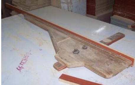
Figura N° 3. Dispositivo de corte utilizado para el despiece.
