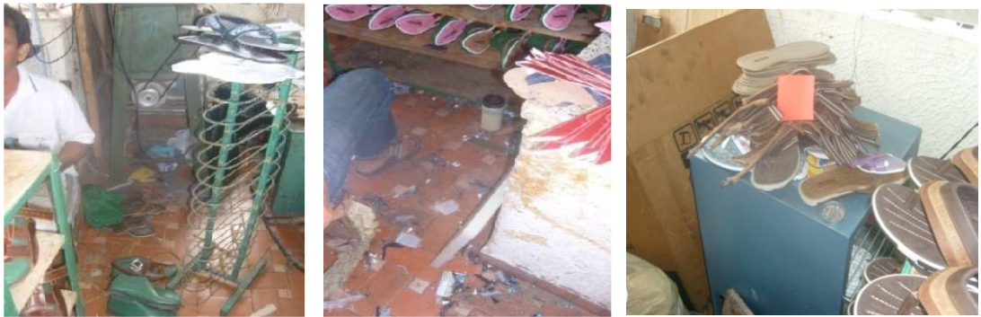
Figura 25. Hormas desordenadas, residuos en el piso, horno dañado.
