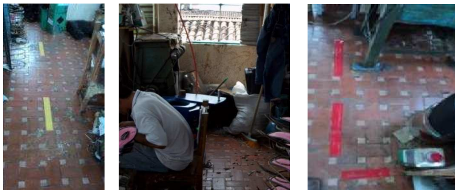
Figura 40. Zona de transporte y zona de peligro área de soldadura
