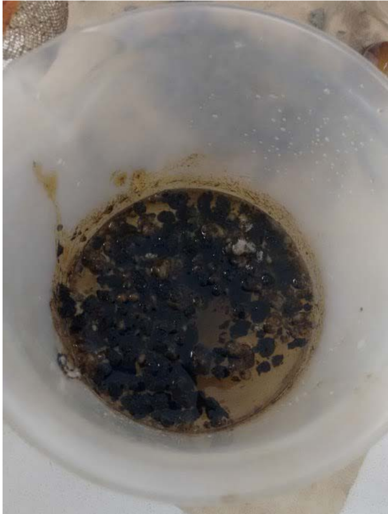
Figura 9 Hidrocarburo adherido al adsorbente NOW
