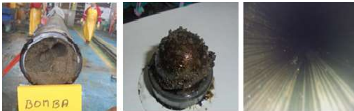
Figura 5. Imágenes de problemas de arena en bombeo mecánico. Adaptado de Gil Carlos (2018). Análisis técnico para determinar las fallas de las bombas de subsuelo del sistema de bombeo mecánico ocasionado por la inyección cíclica de vapor en el campo moriche de Mansarovar Energy Ltda. Bucaramanga. Universidad Industrial de Santander.
