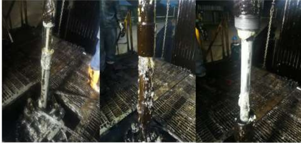
Figura 20. Bomba arenada extraída en el Pozo #134. Mansarovar Energy Colombia (MECL)
