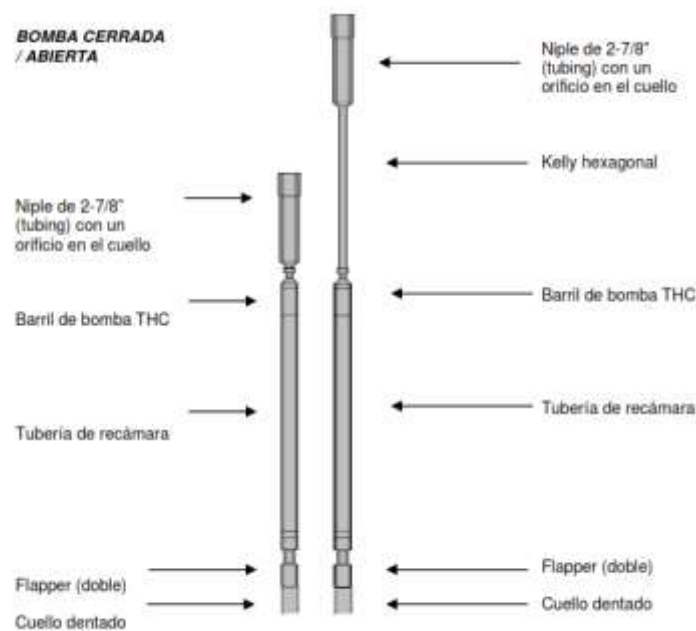
Figura 12 . Componentes de Bomba Desarenadora. Adaptado de Mansarovar Energy Colombia (MECL)
