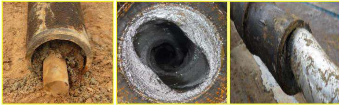
Figura 4. Presencia de arena en sistemas BCP. Adaptado de Monsalve Diego (2015). Evaluación técnica y financiera de la implementación de nuevas tecnologías para la mejora del rendimiento de los sistemas de levantamiento artificial de bombeo por cavidades progresivas. Bucaramanga. Universidad Industrial de Santander
