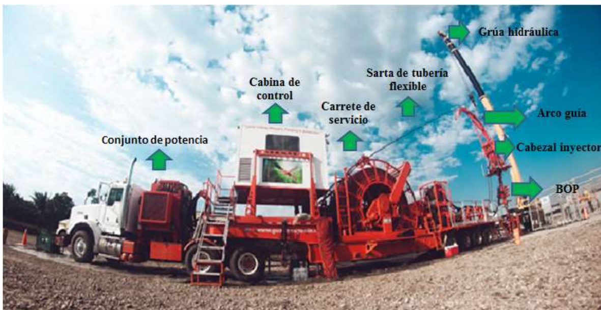
Figura 11. Unidad de Coiled Tubing para Servicio de Limpieza de Arena. Adaptado de Guacamaya Oil Services. Disponible en https://www.guacamayaols.com/limpiezas
