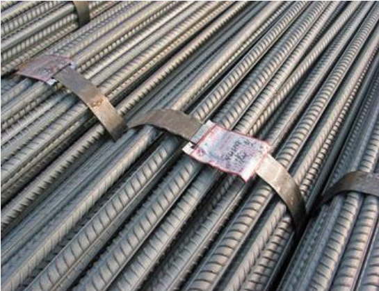
Figura 4. Acero estructural de refuerzo
