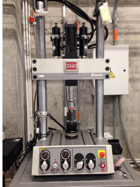
Figura 5. Máquina MTS Bionix Tabletop (MTS Systems Corporation) con una muestra ósea mientras se somete a un ensayo de compresión.
