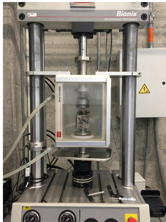
Figura 6. Máquina MTS Bionix Tabletop (MTS Systems Corporation) con el acople de la cámara térmica en el ensayo de fatiga con una muestra ósea embebida.
