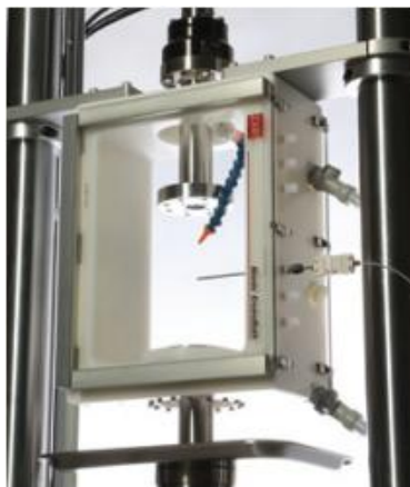
Figura 2. Cámara Bionix Envirobath (MTS Systems Corporation). Adaptada del catálogo MTS Bionix® Tabletop Test Systems.
