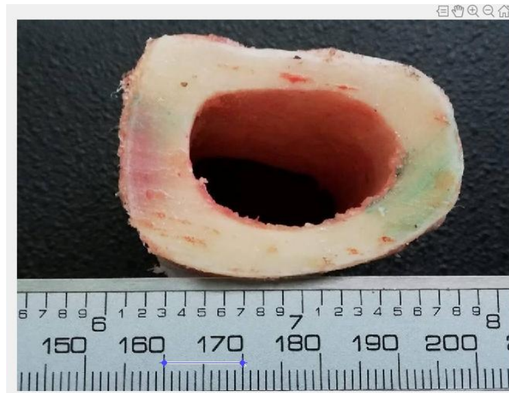
Figura 6. Dimensionamiento de la imagen utilizada para el cálculo del área transversal mediante Matlab.
