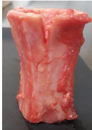
Figura 10. Fallo de una muestra ósea cuando se le aplican cargas de compresión.
