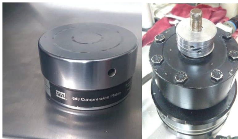
Figura 7. Acoples predeterminados de la máquina MTS Bionix Tabletop (MTS Systems Corporation).
