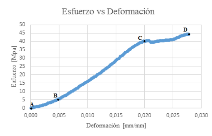
Figura 9. Curva esfuerzo vs deformación para una muestra ósea a una velocidad de 2 mm/min.
