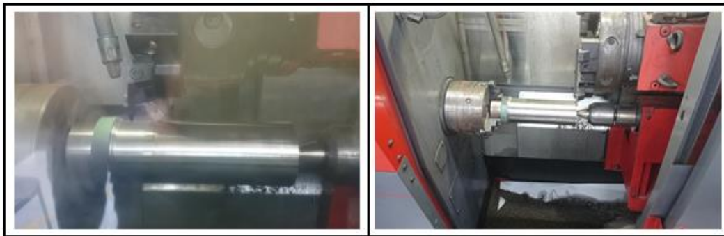
Figura 22. Mecanizado sin lubricante de las probetas en fundición gris.
