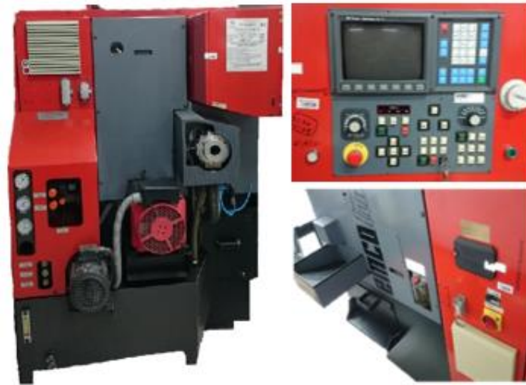
Figura 17. Torno CNC Emco Turn 342 componentes y panel de control.
