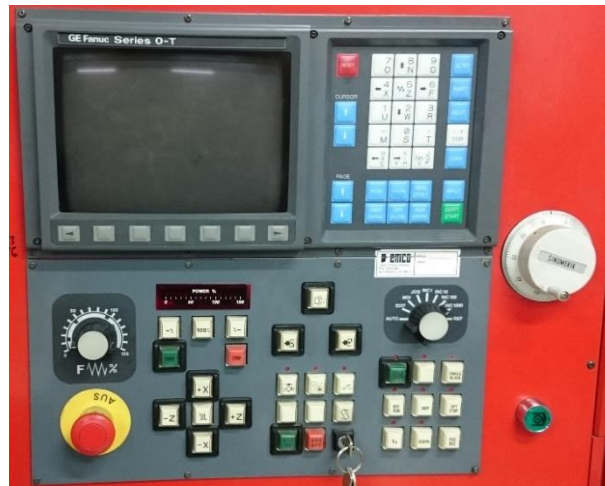
Figura 23. Panel de control del torno CNC.
