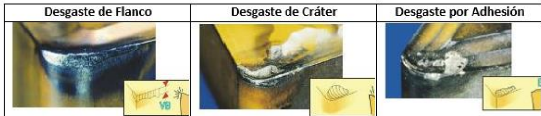
Figura 6. Principales desgastes en insertos de torneado.
