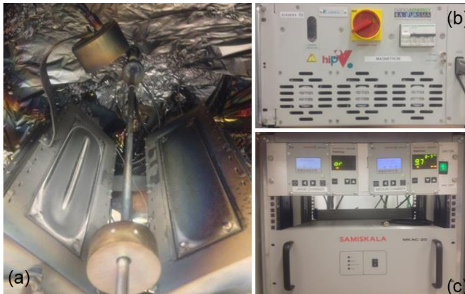
Figura 15. Componentes del sistema HIPIMS. Magnetrones rectangulares (a), fuente HIPIMS (b) y control de presión y temperatura (c).
