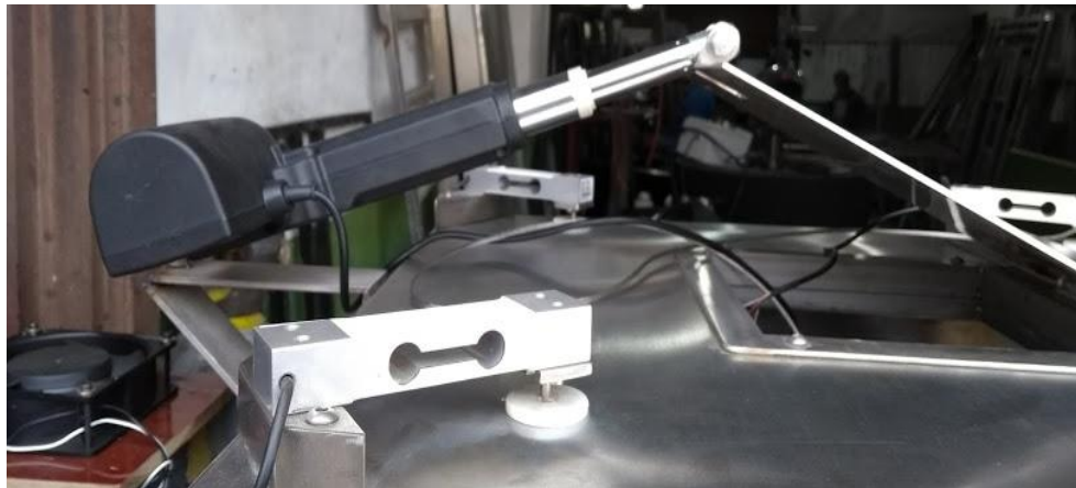
Figura 63. Actuador lineal para la apertura de la compuerta superior
