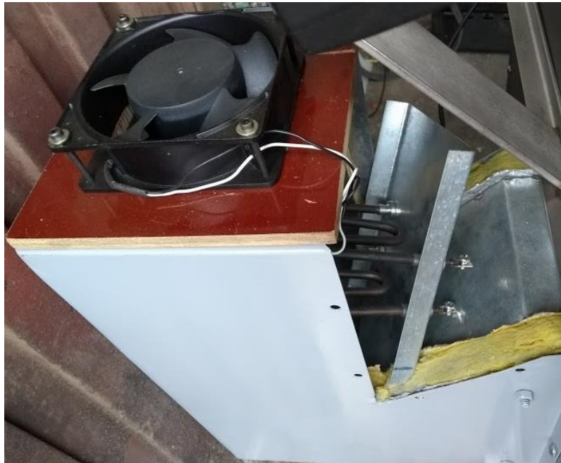
Figura 61. Ducto de calefacción en construcción
