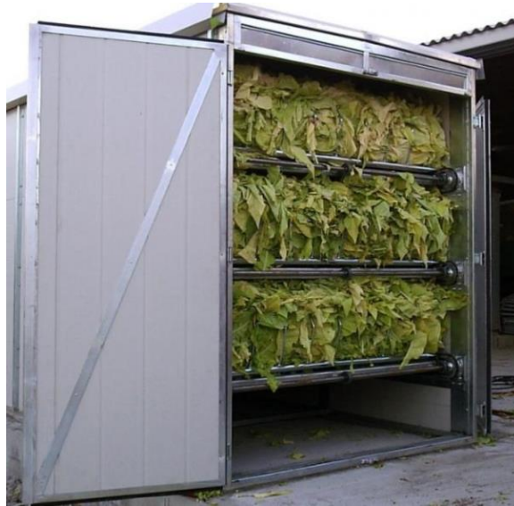
Figura 6 Horno tipo Bulk Cured
