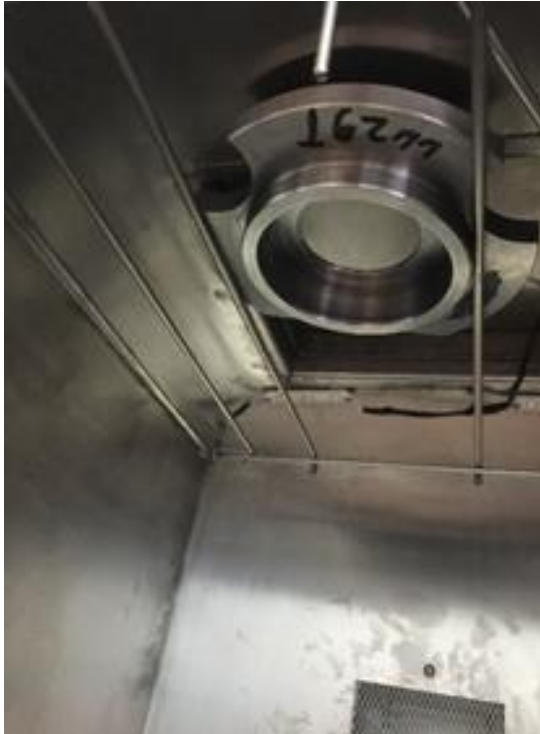
Figura 73. Peso conocido en la parrilla del prototipo.
