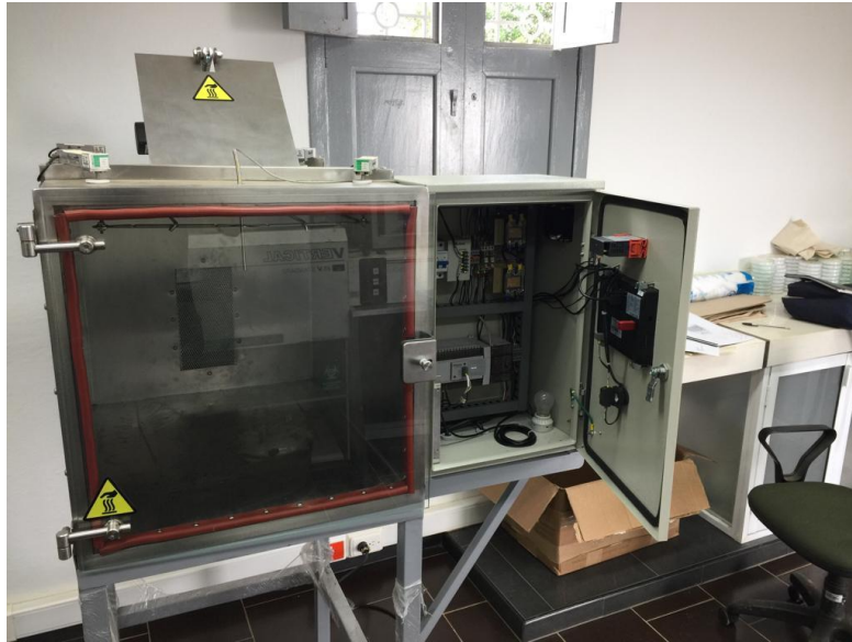
Figura 68. Prototipo de cámara climática con vista a la caja de control.
