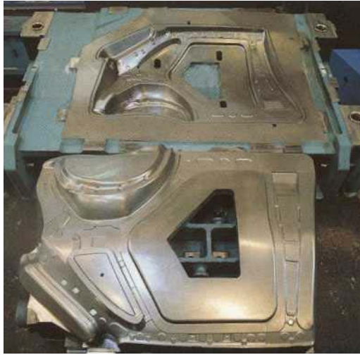
Figura 125. Pieza Obtenida por Estampado
