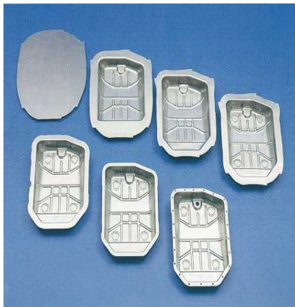
Figura 117. Fases de Fabricación de una Pieza Embutida
