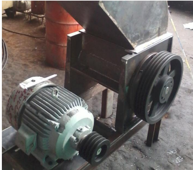
Figura 46. Posición del motor en la máquina Fuente. Autores
