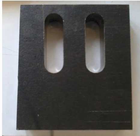
Figura 37. Cuchilla móvil Terminada Fuente. Autores
