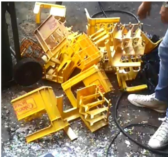
Figura 57. Canastas hechas de PEAD antes y después de la prueba Fuente. Autores
