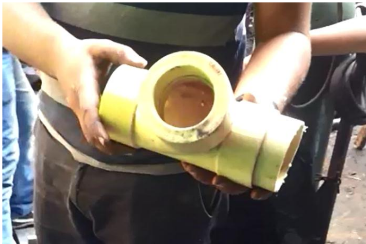
Figura 56. Tubería de prueba para espesor de pared de diseño Fuente. Autores
