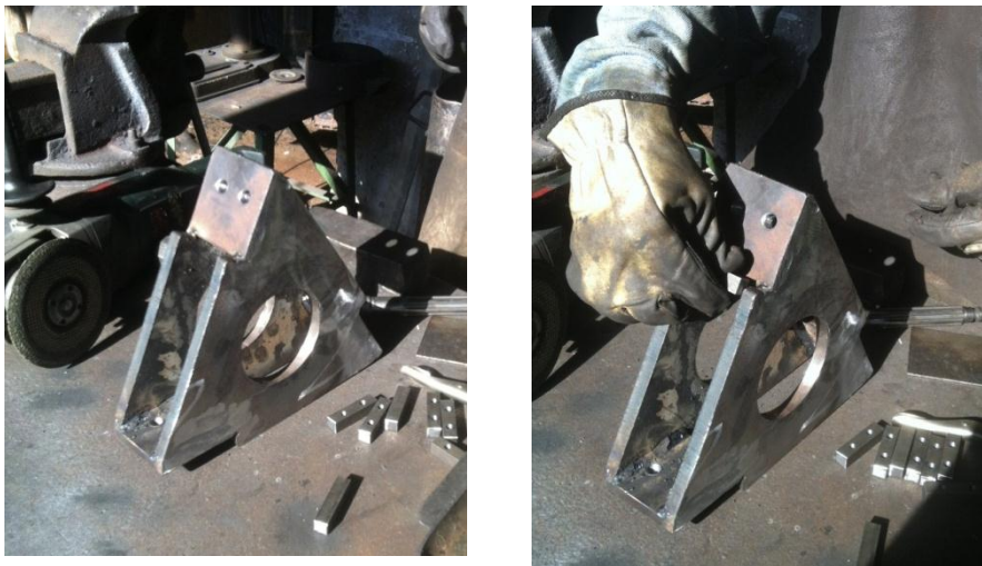
Figura 31. Ensamble de los porta cuchillas Fuente. Autores
