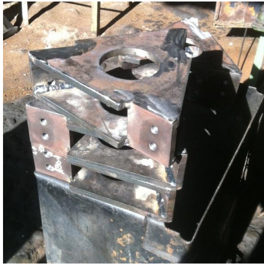
Figura 32. Porta cuchillas terminadas Fuente. Autores
