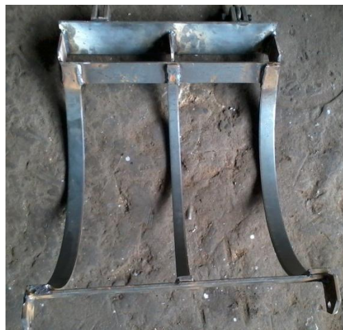
Figura 39. Soporte de la criba Fuente. Autores
