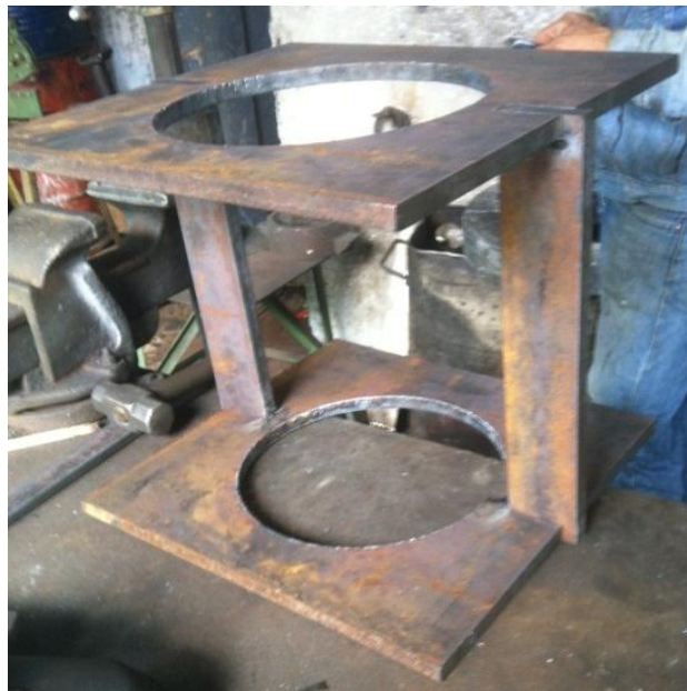
Figura 41. Piezas de construcción de la estructura principal del bastidor Fuente. Autores
