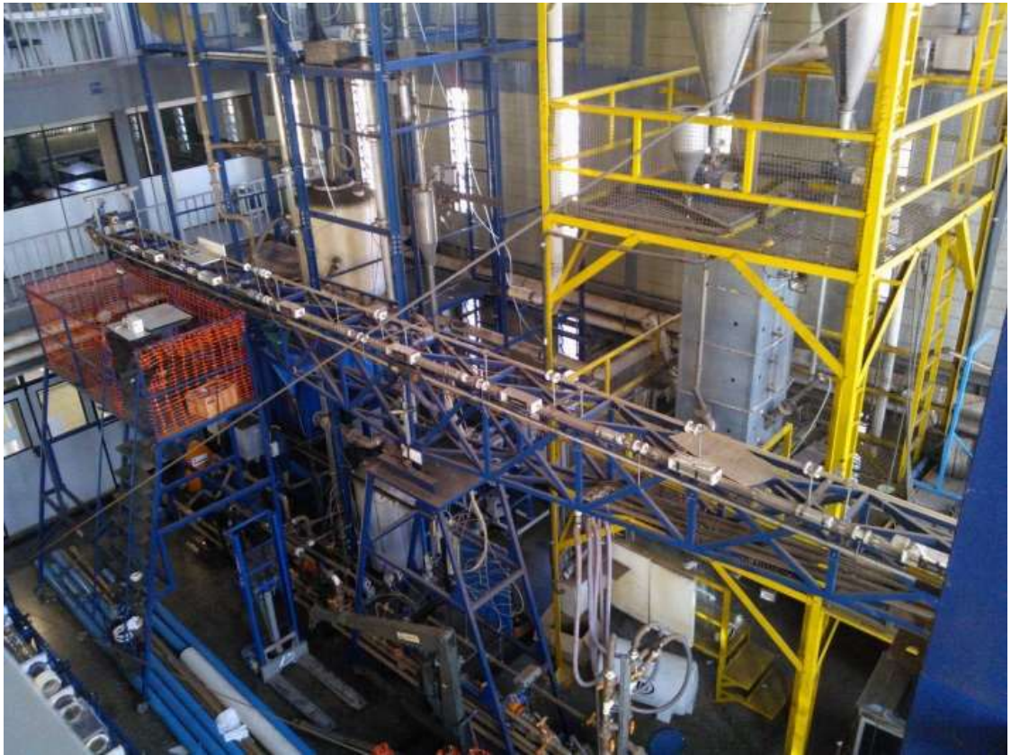
Figura 7. Oleoducto piloto del LETeF listo para la realización de las pruebas.
