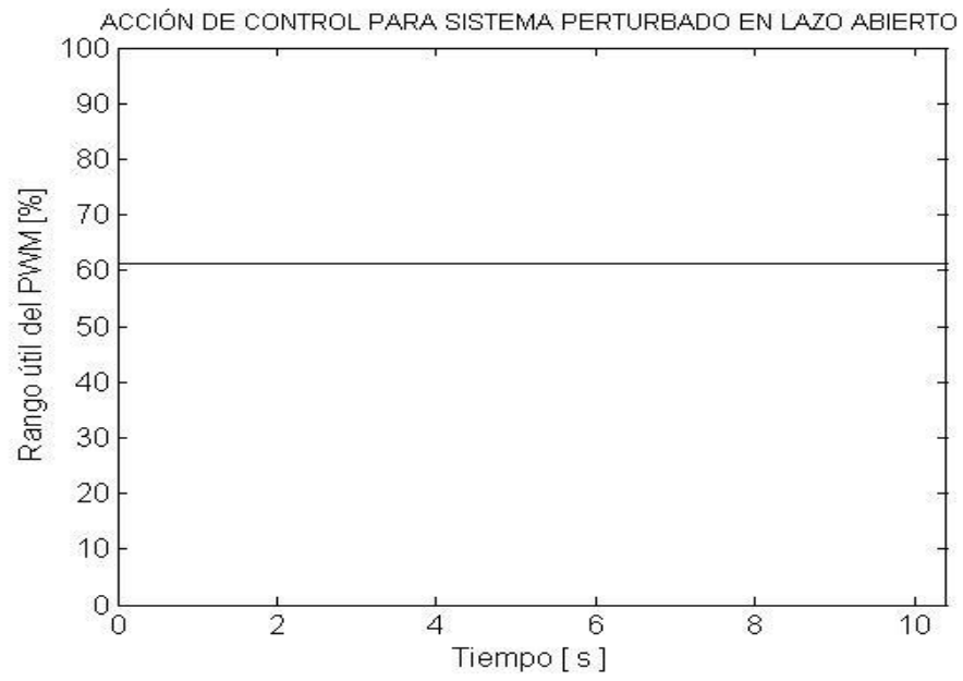
Figura 20 Acción de control para sistema perturbado en lazo abierto
