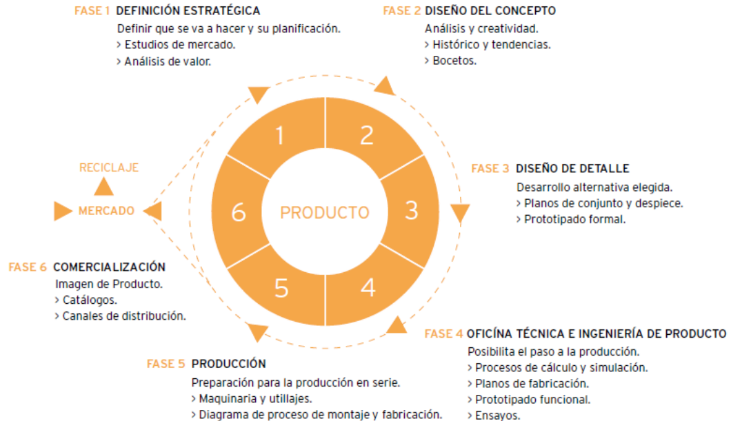
Ilustración 3. Ciclo de vida del producto. Fuente: Guía Metodológica Diseño Industrial. Fundación Prodiotec
