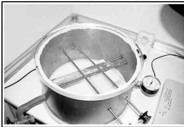
*Nota.* Cámara de vacío utilizada en el Museo de Ciencias Naturales de Álava durante la preparación de muestras de ámbar con resina EPO-TEK 301. Tomado de Corral et al. (1999).
