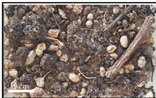
*Nota.* Muestra del horizonte A, se observan pequeñas bolitas de resina (soil beds) que contienen hongos, agregados de humus con cuarzo, algunas raíces, granos de cuarzos y pellets. Tomado de Delclòs et al. (2020).
