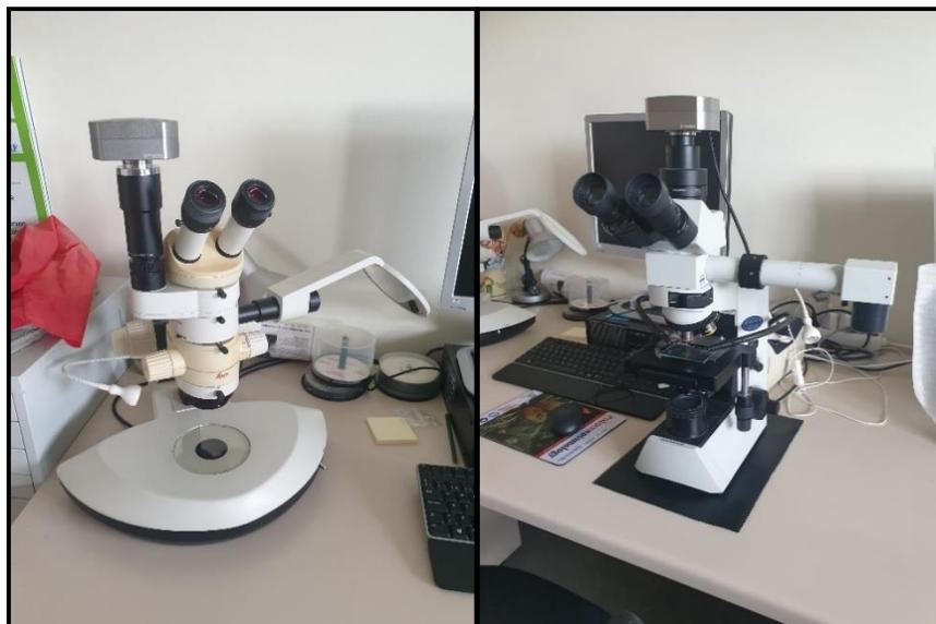
*Nota.* En la izquierda: fotografía de binocular con cámara clara (derecha) y cámara fotográfica (arriba), utilizado para el dibujo y descripción de muestras preparadas. En la derecha: microscopio con cámara clara (tubo ubicado a la derecha) utilizado para el dibujo y descripción de muestras preparadas. La cámara fotográfica (arriba) permite captar imágenes y tomar medidas de las estructuras de detalle a estudiar. Autor: Dr. Xavier Delclòs.
