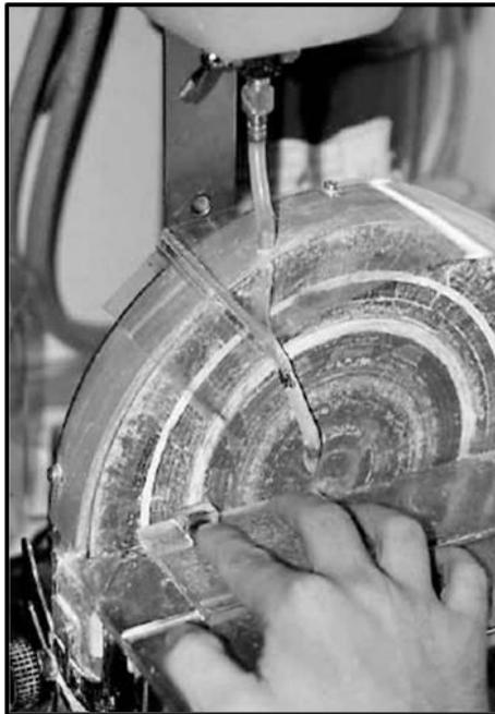
*Nota.* Detalle de la lijadora vertical durante el lijado de un espécimen de ámbar de Álava incluido en resina epoxi. Tomado de Corral et al. (1999).
