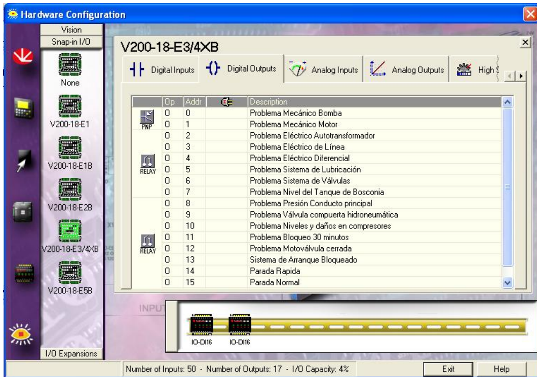
Figura 21. Listado en Visilogic de algunas Variables de Salida por Unidad de Bombeo para el PLC Vision280™
