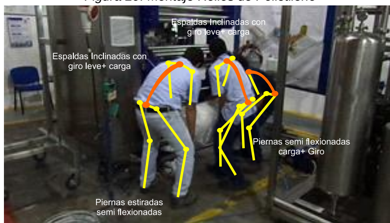
Montaje de rollo en Maquina BAGGER planta ESSi. Imagen tomada por el autor
