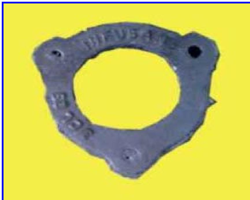
Anexo B. Pieza obtenida después de desmoldar, usando la mezcla de Infusan Ltda. (12% Bentonita, 6% de carbón, 7.6% de agua; 10 minutos de mezcla)
