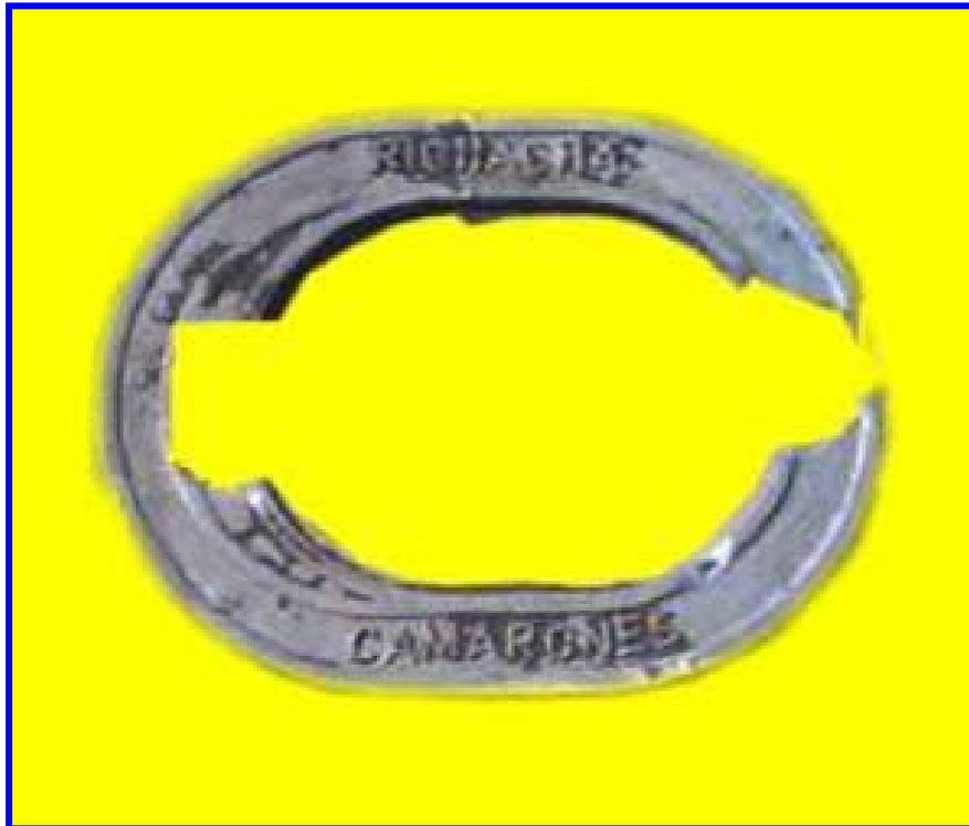
Anexo A. Pieza obtenida después de desmoldar, usando la mezcla de Infusan Ltda. (12% Bentonita, 6% de carbón, 7.6% de agua; 10 minutos de mezcla)
