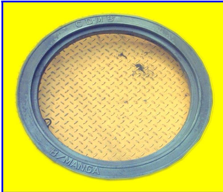
Fotografía 10. Pieza fundida extraída del molde, utilizando la mezcla seleccionada E
