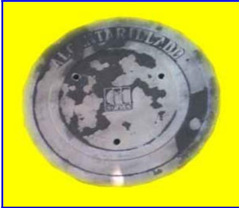
Fotografía 8. Pieza fundida extraída del molde, utilizando la mezcla seleccionada H
