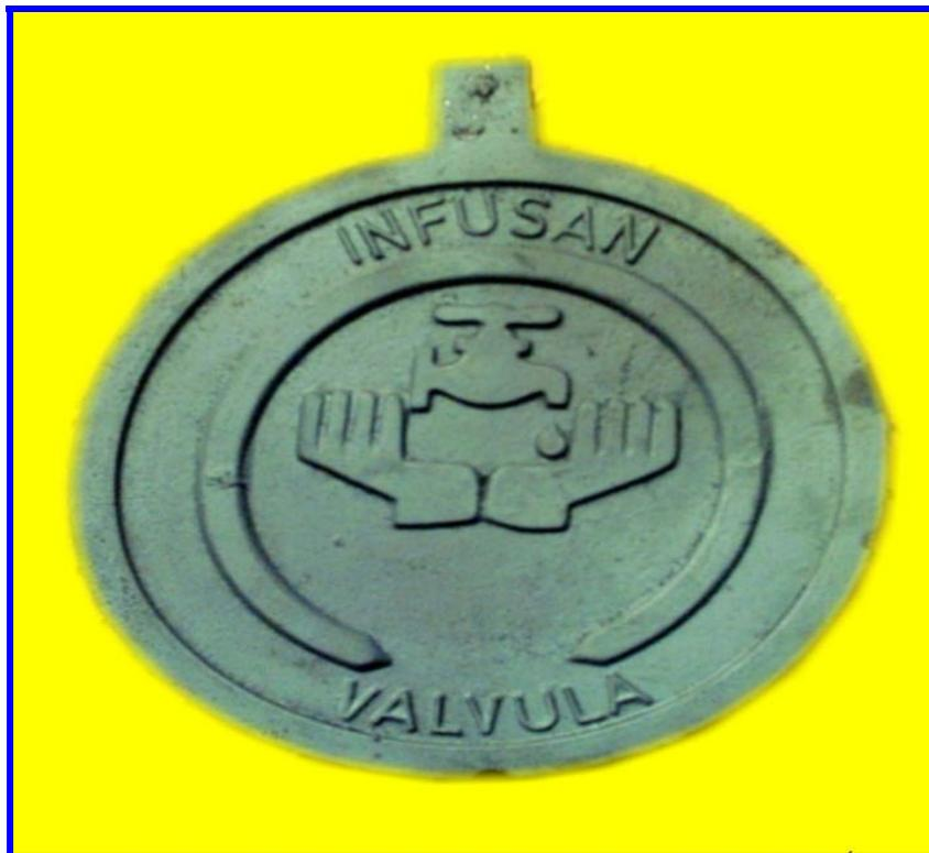
Fotografía 9. Pieza fundida extraída del molde, utilizando la mezcla seleccionada A
