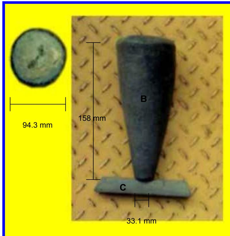
Fotografía 5. Dimensiones del Bebedero usado para la tapa peatonal.
