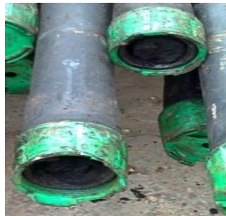
Figura 1. Tuberías de Campo Escuela taponadas por precipitación de parafinas. Fuente: Autores
