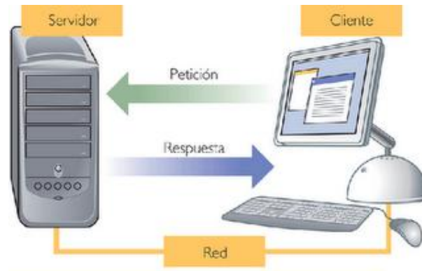
Figura 2. Esquema de Arquitectura Cliente-Servidor de Dos Capas
