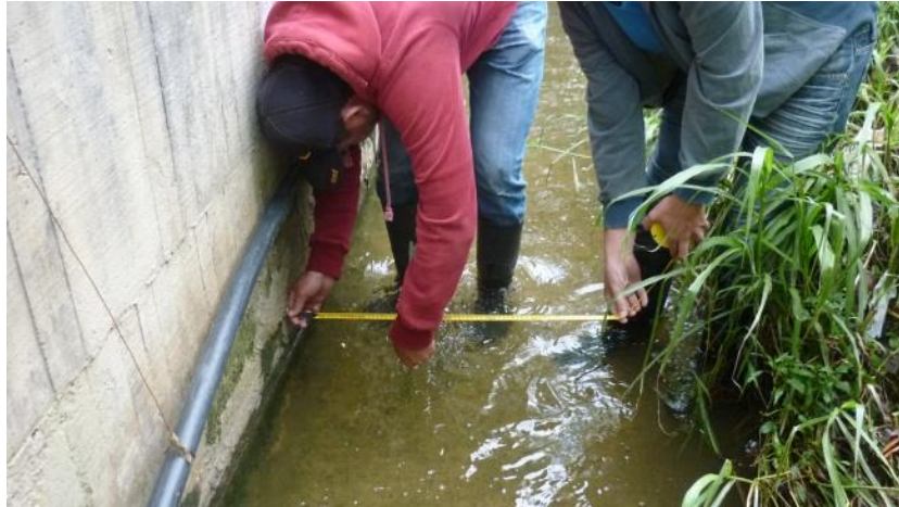
Imagen 5. Medición Sección Transversal Quebrada La Malagueña.
