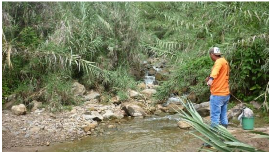
Imagen 31 . Método del Flotador Parte Media Salado Bravo
