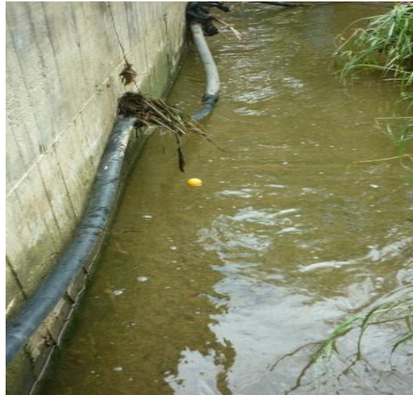
Imagen 6 . Método del Flotador Parte Media Quebrada La Malagueña.
