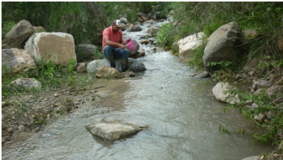
Imagen 28. Método del Flotador Parte Baja “Sagamal”
