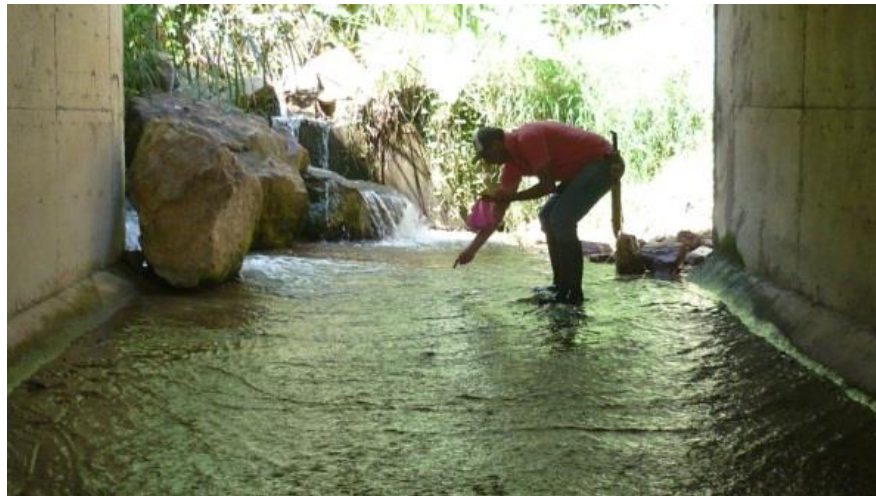
Imagen 26. Método del Flotador Parte Media “Sagamal”
