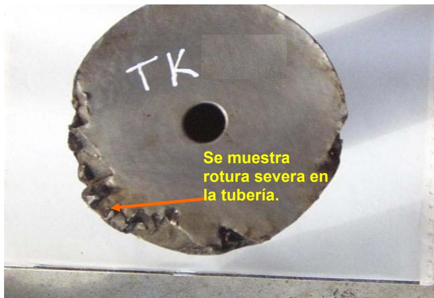
**8.2.3 Fugas de vapor en las líneas del campo.** Debido a las altas presiones que se manejan en el sistema de vapor, ayudado en algunos casos del mal estado de las válvulas de seguridad de los *Manifolds*, se presentan con frecuencia fugas de vapor a lo largo del campo, incrementando así las pérdidas de calor en superficie, y que perjudica directamente la calidad final en la cabeza del pozo, presentándose una expansión térmica en la zona de fuga.
