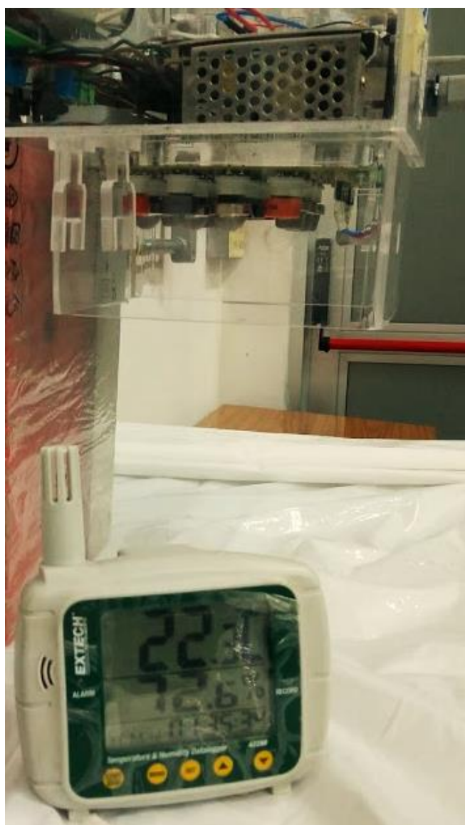
Figura 29. Prototipo de nariz electrónica para identificar insectos vectores del mal de Chagas.
