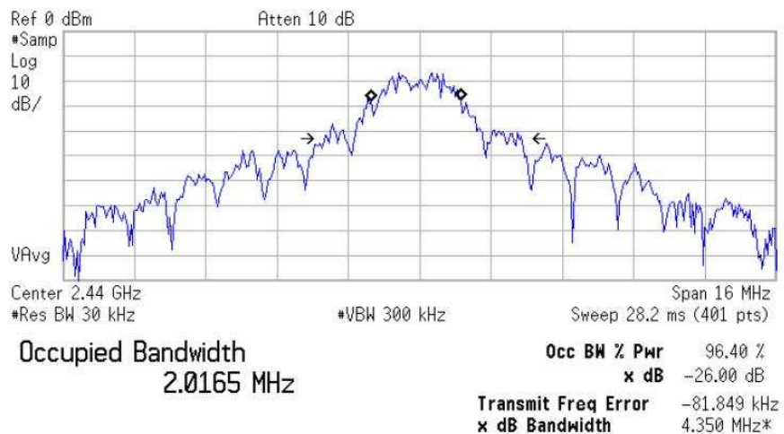
Figura 65. Distribución de potencia en el ancho de banda de un canal IEEE 802.15.4
