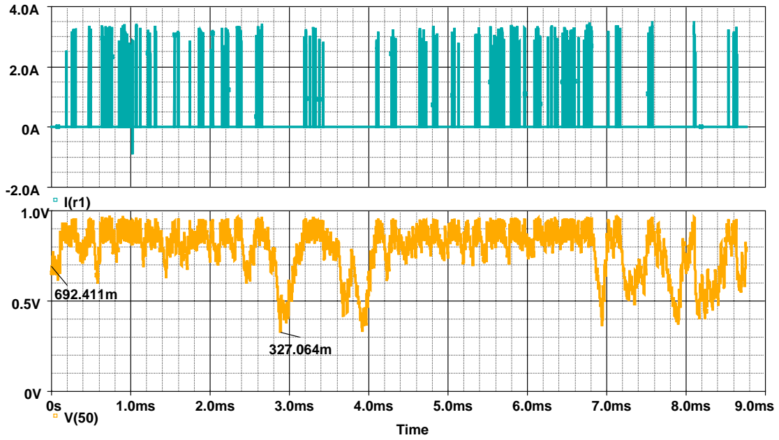
Figura 7. Corriente de desbordamiento en el transistor (arriba), y SOC en la batería (abajo). Nota: el eje vertical corresponde a horas en lugar de \mu s. Por conveniencia, se tomó que 1 \mu s equivale a 1 hora.
