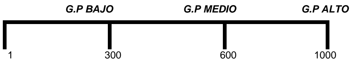
Figura 5. Escala de grado de peligrosidad.
