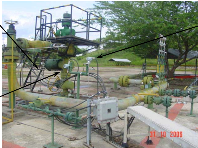
Foto 2. Cabeza del pozo productor elegido para la prueba
