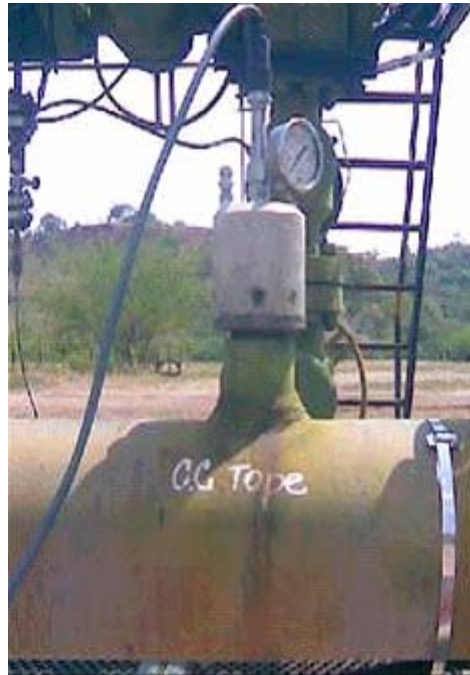
Foto 1. Probeta de respuesta rápida, instalada cabeza de pozo
