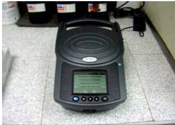
Foto 5. Espectrofotómetro DR 2010 para determinación de hierros totales
