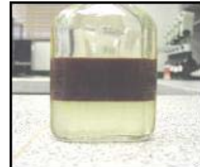
Figura 5. Blanco para pruebas de emulsión, mezcla (1:1) de agua y crudo
