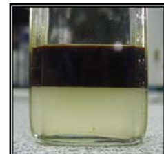
Figura 6. Mezcla (1:1) de agua crudo con 500 ppm del inhibidor A y el inhibidor EP, para pruebas de compatibilidad
