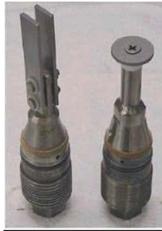
Figura 20. Cupones estándares y de disco, para monitoreo de corrosión interna
