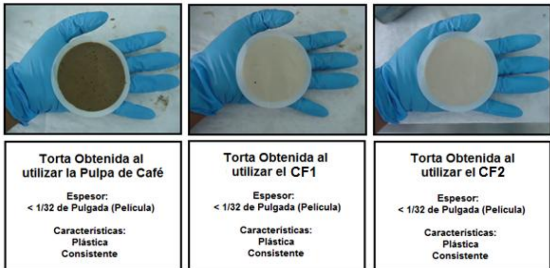
FIGURA 49. Comparación de los resultados del Filtrado API a diferentes concentraciones de los productos evaluados
