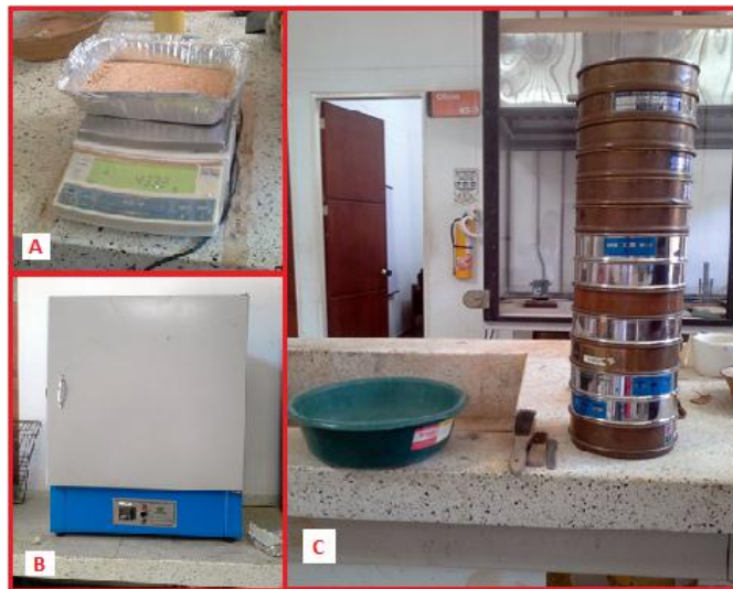
Figura 4. Materiales utilizados en la realización del ensayo granulométrico. A) Báscula Shimadzu UW82005, Bandeja desechable de papel aluminio. B) Horno digital de precisión Pinzuar modelo PG190. C) Recipiente para almacenar agua, Tamices que van desde el número 2 al 200.
