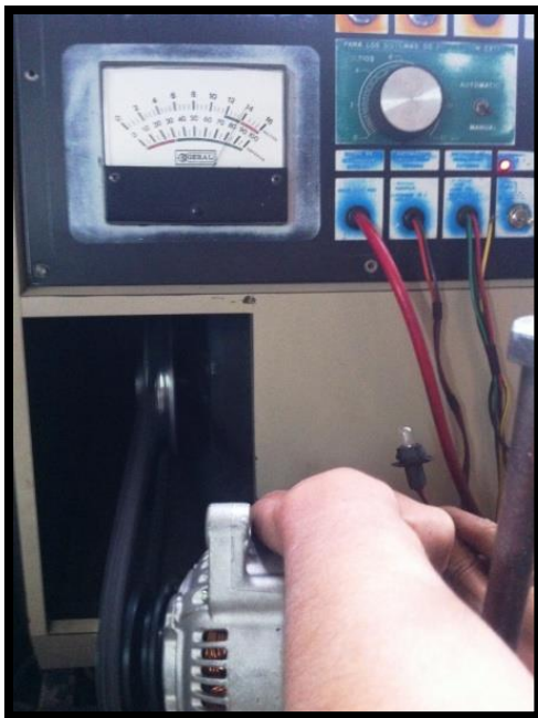
Imagen. Alternador en equipo de prueba. Fuente. Propia.
