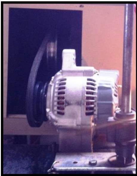
Imagen. Alternador en equipo de prueba. Fuente. Propia.
