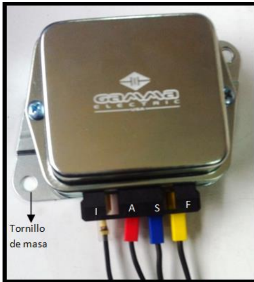
Imagen. Regulador Externo. Fuente. Propia.
