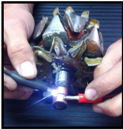
Imagen. Prueba de Bobina Rotor. Fuente. Propia.
