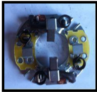
Imagen 1. Porta Escobillas y Escobillas en Buen Estado. Fuente. Propia.
