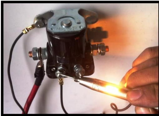
Imagen. Solenoide auxiliar prueba señal de start. Fuente. Propia.
