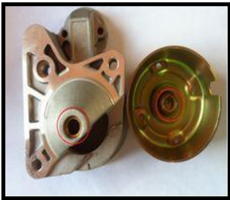
Imagen. Dentro del Circulo se Observan los Bujes. Fuente. Propia.
