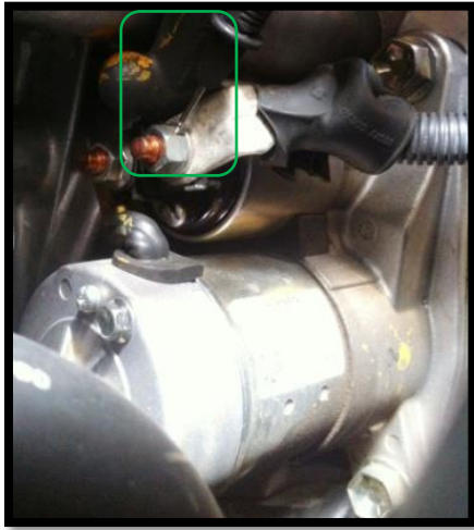
Imagen. Punta de prueba negativa en el motor de arranque. Fuente. Propia.
