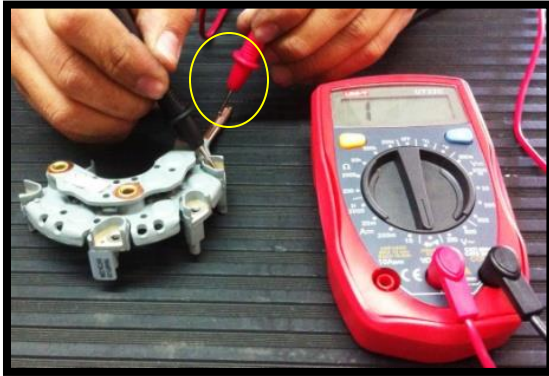
Imagen .Prueba a Rectificador Intercambiando Las Puntas de el Multímetro. Fuente. Propia.
