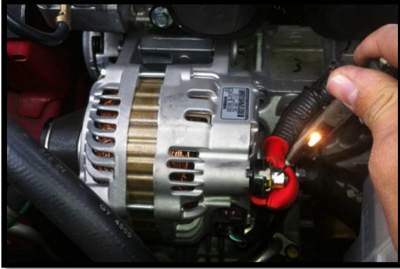
Imagen. Prueba de corriente al alternador con punta de prueba. Fuente. Propia.
