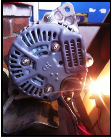
Imagen. Conexión de Alternador en Equipo de Prueba. Fuente. Propia.
