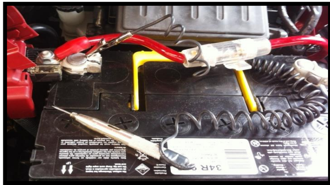
Imagen10. Prueba de Masa, Pinza en Borne Positivo Fuente. Propia.
