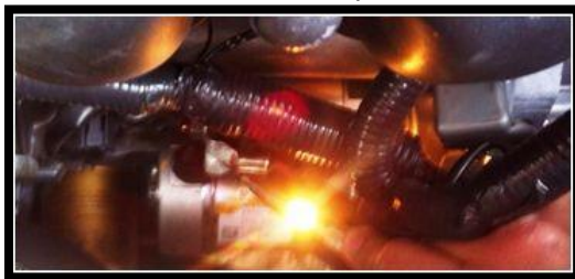
Imagen. Prueba al cable de la batería en solenoide motor de arranque. Fuente. Propia.
