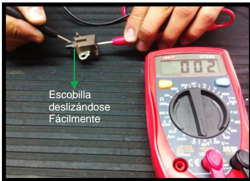
Imagen. Inspección de Escobillas y Porta Escobilla. Fuente. Propia.
