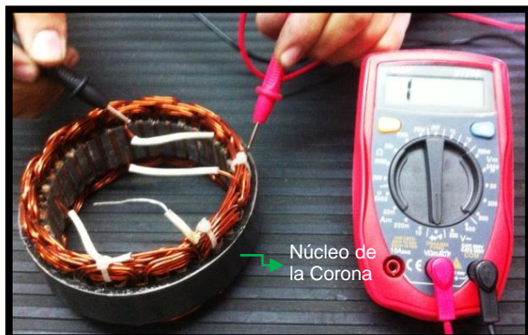
Imagen. Prueba de continuidad entre el Núcleo y las puntas de Salida. Fuente. Propia.
