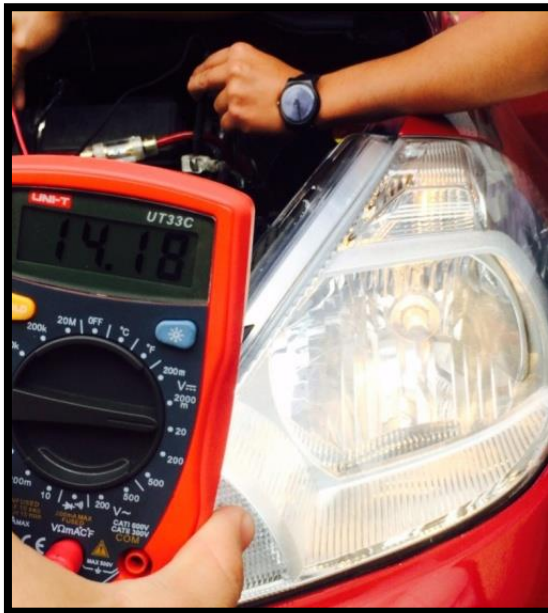
Imagen .Multímetro conectado para medir voltaje de sistema de carga con luces prendidas. Fuente. Propia.
