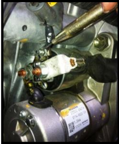
Imagen. Prueba de señal de start en el motor de Arranque. Fuente. Propia.
