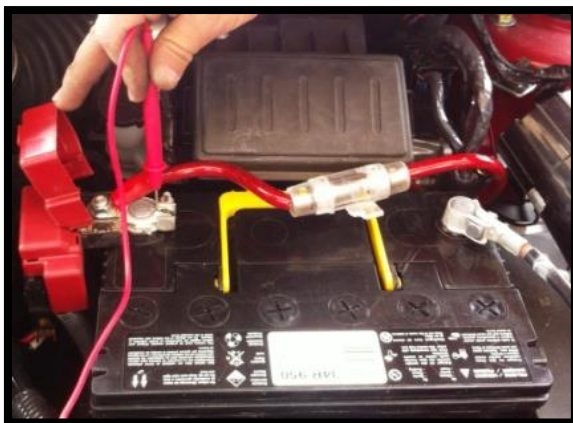
Imagen. Punta de prueba del multímetro en el poste de la batería. Fuente. Propia.
