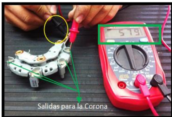
Imagen. Prueba a Rectificador. Fuente. Propia.
