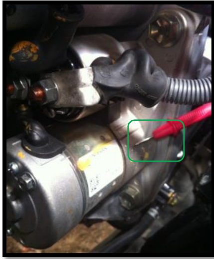
Imagen. Punta de prueba positiva en carcasa motor de arranque. Fuente. Propia.
