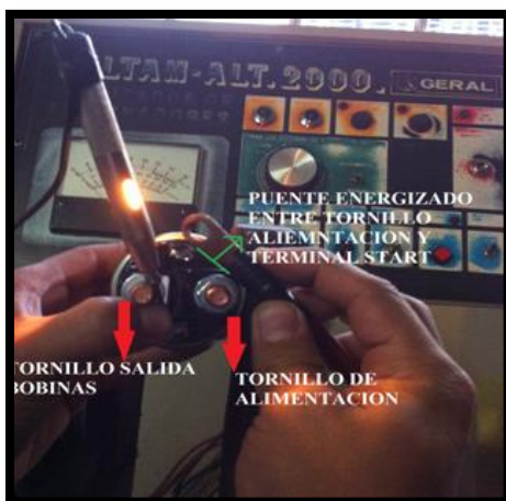
Imagen .Prueba de salida de bobinas en el solenoide. Fuente. Propia.
