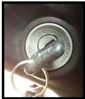
Imagen. Switch de Encendido en posición START . Fuente. Propia.
