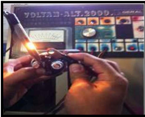
Imagen. Puente entre la alimentación y la terminal de "start". Fuente. Propia.
