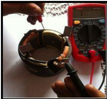
Imagen. Prueba de Bobinas de Campo. Fuente. Propia.
