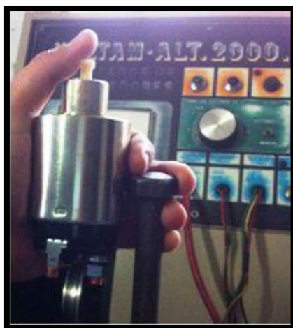
Imagen .Solenoides Con masa en su carcasa. Fuente. Propia.
