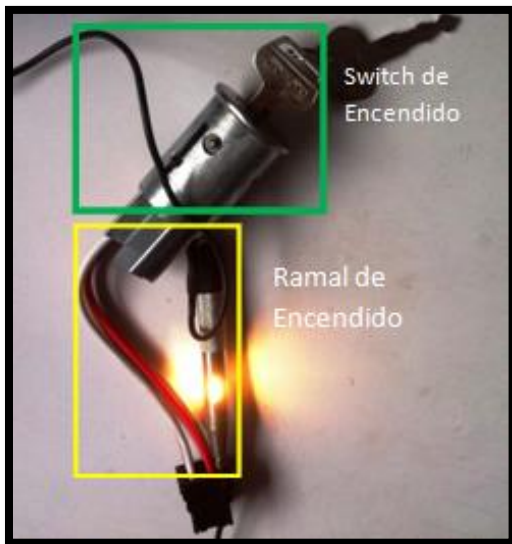
Imagen. Switch de Encendido y Ramal. Fuente. Propia.
