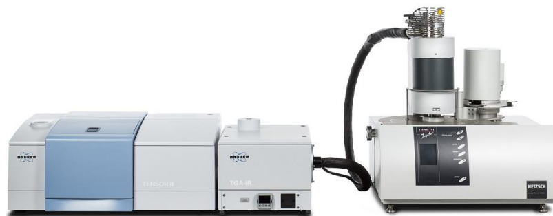
Figura 20. Equipo TGA-DSC NETZSCH STA 449 F3 Jupiter
