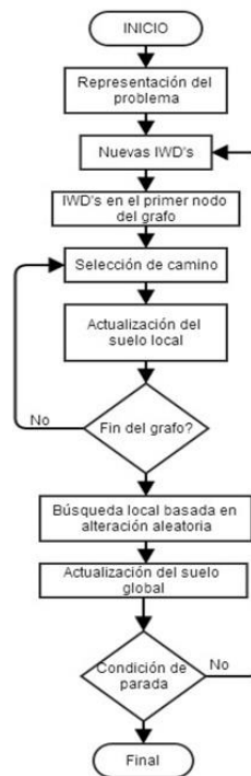
Figura 7. Diagrama de flujo del algoritmo IWD Continuo.
