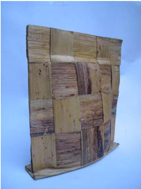
Se ha evolucionado el contenedor rígido moldeado con calor y constituido por tiras entrelazadas de cascarón de plátano aglomeradas entre sí con almidón, a través de la experimentación se ha llegado a obtener el mismo elemento sin necesidad de pasar por un proceso de moldeo. También se propone el uso de una película interna de Carboximetilcelulosa para proteger el café de agentes externos, se obtiene de la síntesis de las plantas y es biodegradable.
