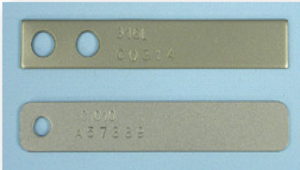
Figura 24. Ejemplos de Cupones de Corrosión.
