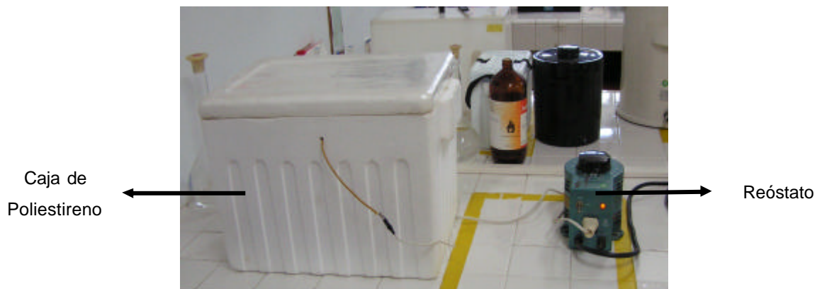
Figura 10. Sistema para el control de la temperatura de la solución Hanks.
