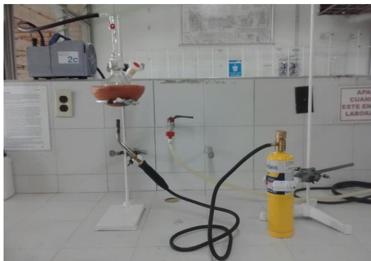
Figura 14. Montaje experimental pirólisis de la yuca.
