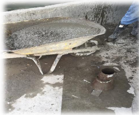
Figura 21. Materiales empleados para la prueba de asentamiento.
