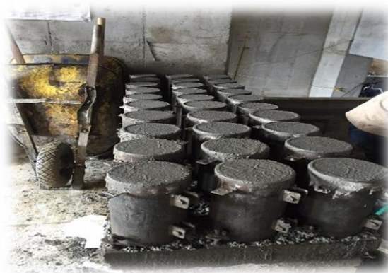
Figura 22. Muestro de concreto en obra.
