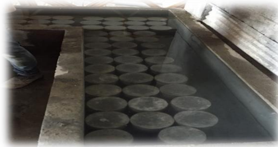
Figura 23. Pila en obra para el proceso de curado de las muestras de concreto.
