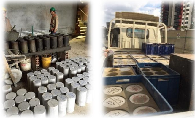
Figura 24. Muestras de concreto listas y enviadas al laboratorio
