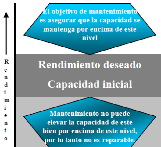
Figura 14. Una situación fuera del alcance de mantenimiento.
